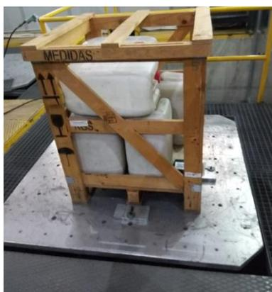
Ilustración 27. Proceso de simulación de transporte en la máquina de vibración de AIDIMME.
