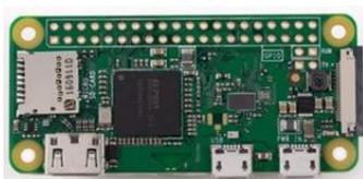
Ilustración 2. Tarjeta Raspberry Pi Zero W
